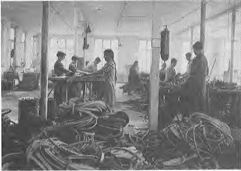
Die aufgeschnittenen Autopneureifen wurden zu Matten verarbeitet
