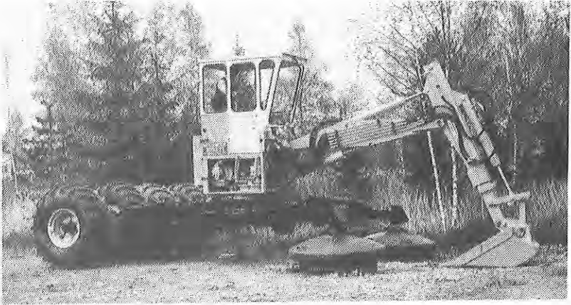
1976 Lancierung des Typs 3000-T1, der mit einem hydraulischen Ausleger ausgerüstet und 1 m teleskopierbar war. Das Gewicht betrug 5000 kg
