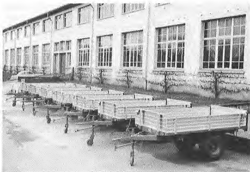
Einachstraktoranhänger für die Landwirtschaft mit Zapfenwellen-Kippvorrichtung
