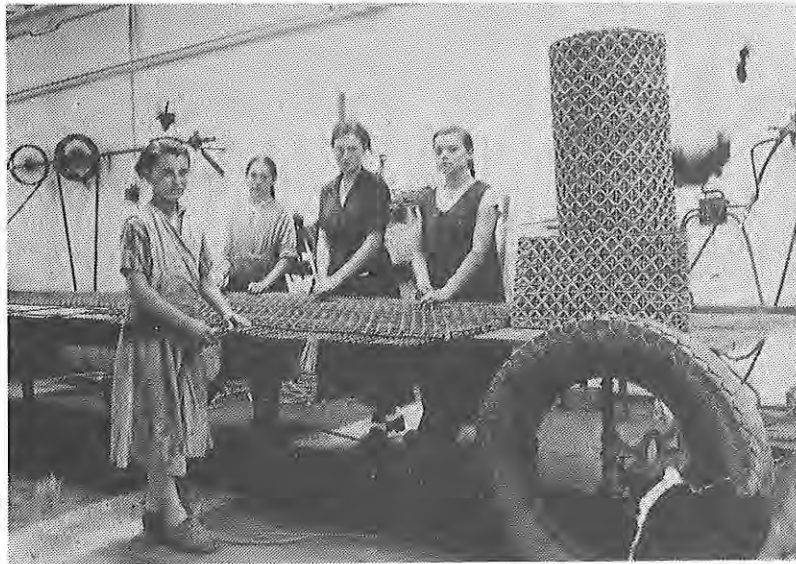
Die aufgeschnittenen Autopneureifen wurden zu Matten verarbeitet
